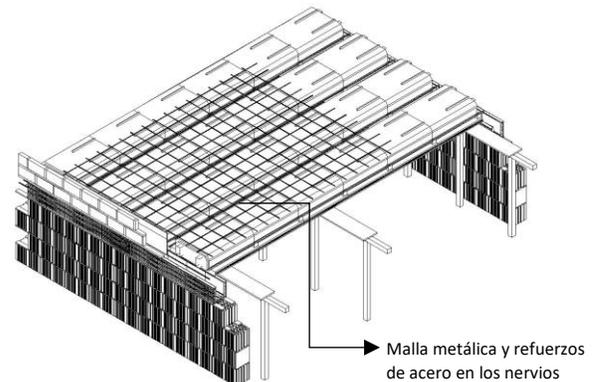
Terminado el proceso de montaje de los componentes de acero, se procede al volcado del hormigón para la conformación de la capa de compresión cuya calidad y espesor estará indicada por el profesional a cargo de los cálculos estructurales. Para todos los casos se recomienda el uso de piedra 6/12 y vibración mecánica para evitar nidos en los nervios.
