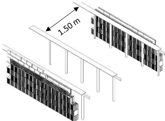
Con los puntales ya posicionados se apoyarán las salientes metálicas de la tira de TecnoPex sobre los elementos estructurales. El montaje de los bloques se debe comenzar por una de las puntas para facilitar el machimbrado longitudinal de los bloques.
